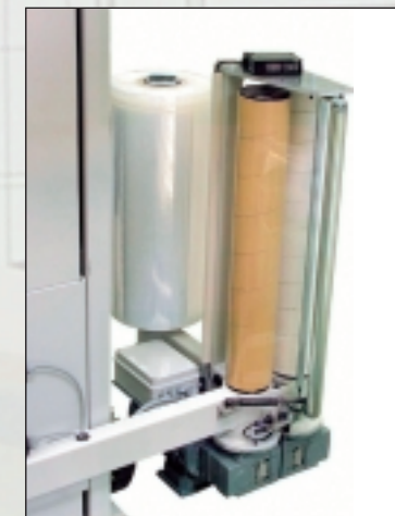
◀ Trinløs justerbart dobbeltmotoriseret folieforstræk. 0-350%. Elektronisk styret.
